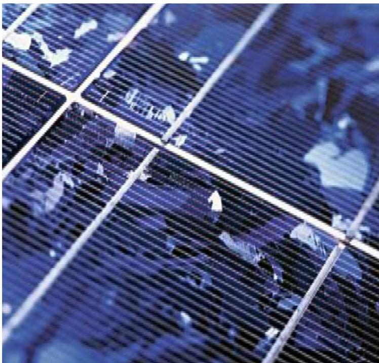
particolare di cella fotovoltaica in silicio policristallino
