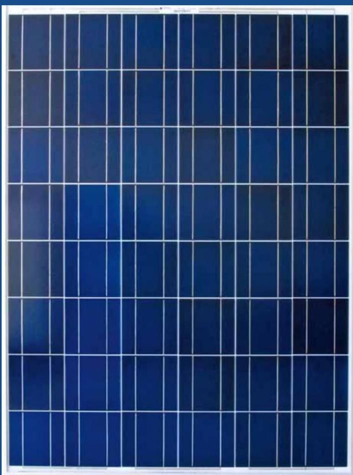
Modulo composto da 48 celle solari (dim. 156x156 mm) in silicio policristallino. Famiglie di potenza da 160 a 180 Wp
